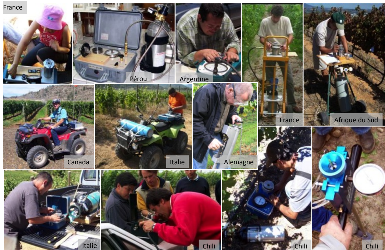
Figure 4 : Détermination de l'état hydrique de la vigne avec la chambre à pression
