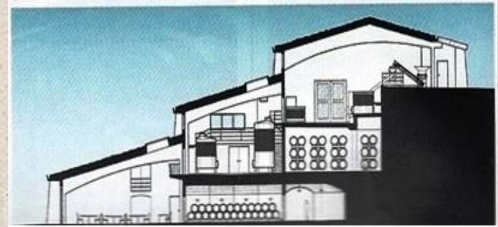
■ Photo 5: Woollaston Estates Winery, vue en coupe de la conception « en escalier » d'une installation à écoulement par gravité (Nelson, Nouvelle-Zélande).
